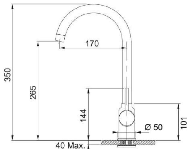
Ruotabile di 360°. Tubo di collegamento 40 cm. Portata d'acqua 12,6 l/min. (3 barre).
